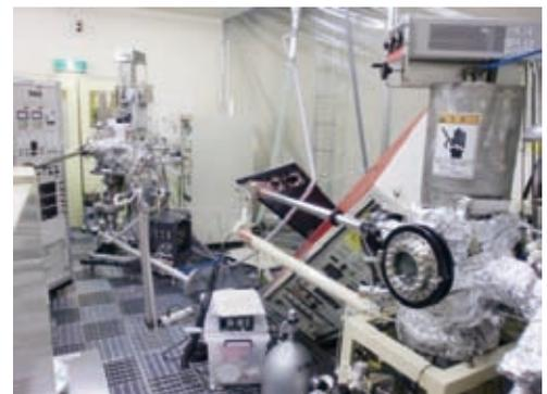
図2 本体が大きく移動し、ラックが転倒したスパッタ成膜装置
