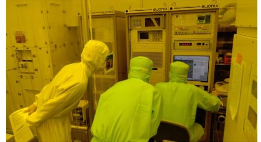
電子線描画装置による微細パターン作製実習
