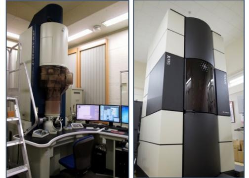
図1.超高分解能収差補正型分析透過電子顕微鏡
