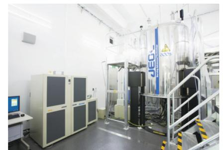
図1. 800 MHz強磁場核磁気共鳴装置
