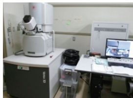
図1. 新機種のFIB (Versa3D)。高分解能観察に適したTEM薄片試料を作製できます。
