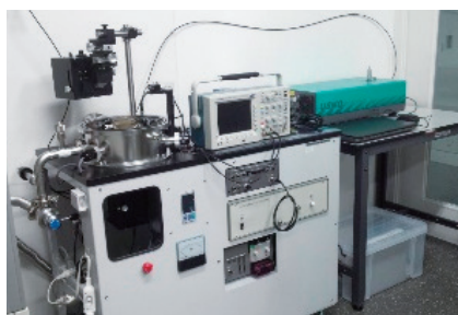
光励起キャリア移動度測定装置
