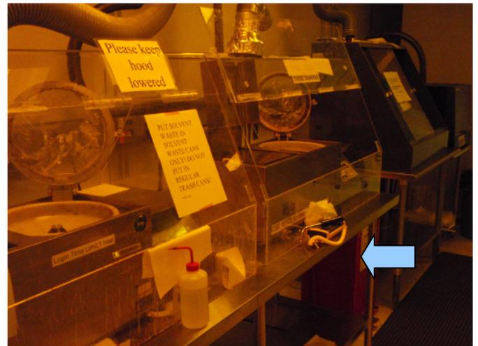
図 4. スピンコーター。アクリル製の容器内は排気されており，有機溶剤が室内に拡散しないよう工夫されている。矢印の位置に見える赤いゴミ箱も有機溶剤付着物用であり，内部が排気されている。
