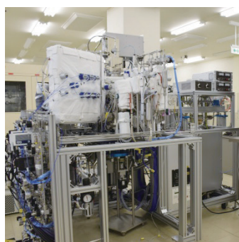
多元材料原子層堆積 (ALD) 装置と Pt 成膜例。 (写真提供: 宮城県産業技術総合センター 阿部宏之博士)
