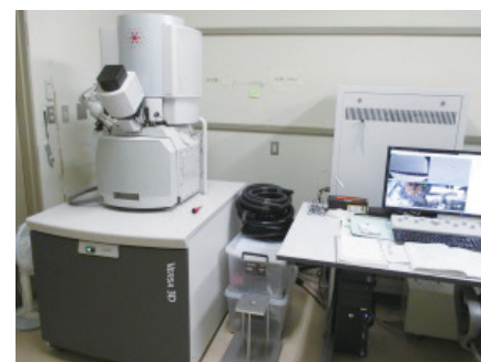
図1. デュアルビーム加工装置(FIB-SEM) Thermo Fisher (FEI) VERSA 3D 微細加工用の電界蒸発型Gaイオン銃と電界放射型走査型電子顕微鏡(FE-SEM)を搭載し、高度な観察機能と微細加工機能、及び高分解能観察TEM試料の作成出来ます。
