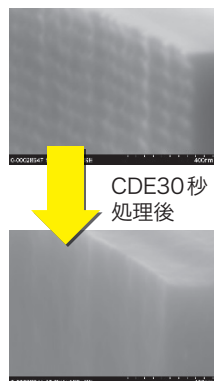
ケミカルドライエッチャー (CDE) と DRIE 後のスキヤロップ除去例。 (写真提供: 東北大学多元研百生研 佐本哲雄博士)
