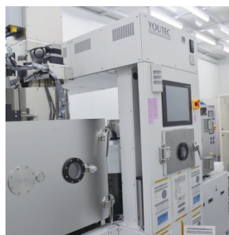
酸素加圧 RTA 付高温スパッタ装置と PZT 成膜後の XRD 測定結果。
