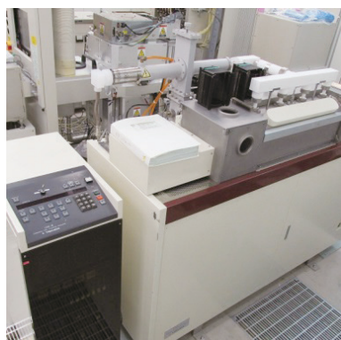
ケミカルドライエッチャー (CDE) と DRIE 後のスキヤロップ除去例。 (写真提供: 東北大学多元研百生研 佐本哲雄博士)
