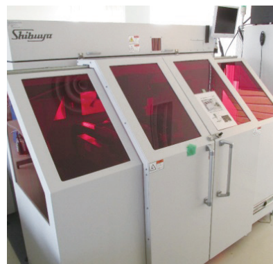
ウォーターレーザとシリコンウェハくり抜き加工例。
