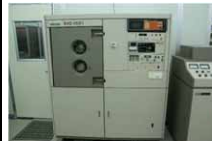
電子ビーム蒸着装置
