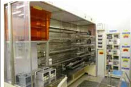
酸化・拡散炉
